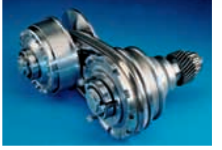
De duwband van de CVT van Van Doorne's Transmissie loopt over twee beweegbare conische schijven continue schakelen door van diameter te veranderen.
